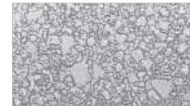
Feinstkorn-Hartmetall-Kornstruktur Ultra-Micro-Grain, Korngrößen 0–0,5 µm. Finegrain-hardmetal structure Ultra-micro-grain, grain size 0–0.5 micron. Struttura dei granuli di metallo duro Ultra Micro Grana (max 0,5 micron).
