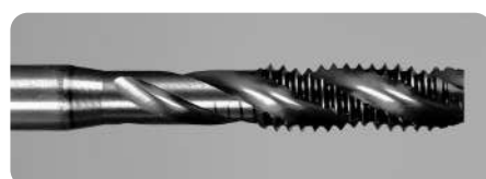
Форма «С» винтовые канавки (2-3 витка)
